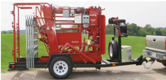
**Model H★T** погрузка и разгрузка становится приятным занятием с нашим прицепом, конструируемым по заказу. Съемные стойки поддерживают станок во время его подъема. Нужно только отогнать прицеп. Менее чем через 5 мин. станок готов к использованию.
